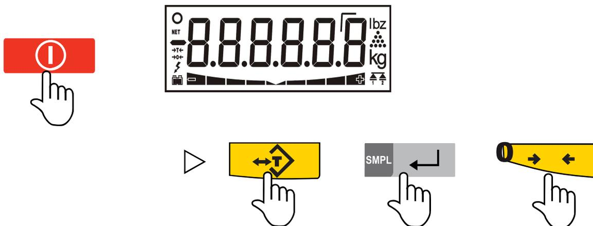
A la mise sous tension, appuyez **simultanément** sur les 3 touches.
