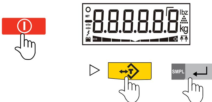
A la mise sous tension, appuyer **simultanément** sur les 2 touches.
