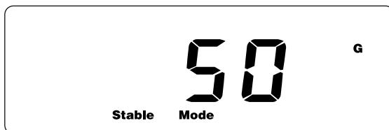
Le processus d'échantillonnage est finalisé et la balance est préparée pour effectuer le comptage des pièces.
